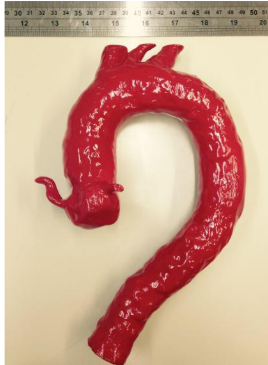
Figura 16. Modelo aórtico tridimensional. Modelo aórtico 3D em material termoplástico ABS-M30 Affordable FDM (Stratasys, EUA) impresso no equipamento Stratasys Fortus 400 mc Systems (Stratasys, EUA). Núcleo de Experimentação Tridimensional – NEXT, PUC-Rio.
