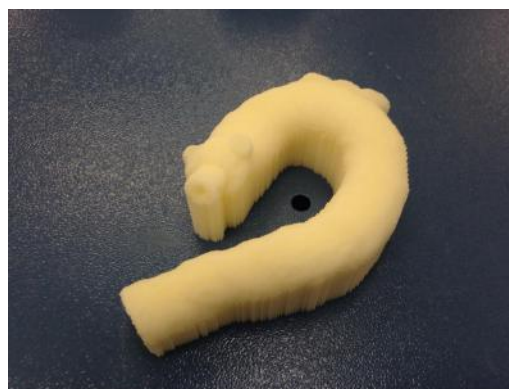
Figura 15. Modelo aórtico com material de suporte. Modelo aórtico tridimensional, ainda com material de suporte utilizado na técnica de prototipagem rápida.
