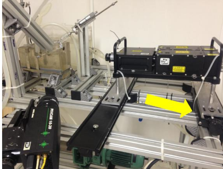
Figura 41. Mesa de coordenadas. Laser acoplado à mesa de coordenadas milimétrica (seta amarela).
