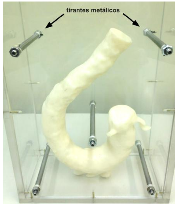
Figura 18. Recipiente de acrílico. Recipiente de acrílico com o modelo aórtico 3D (não impermeabilizado) em seu interior, antes da colocação do elastômero de silicone. As setas evidenciam os tirantes metálicos responsáveis pelo posterior acoplamento das partes de silicone do fantoma aórtico.
