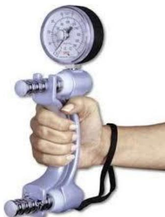
Figura 4: Dinamômetro para avaliação de preensão palmar.
